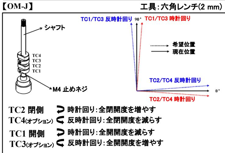
4. 電源を入れてアクチュエータを全開位置まで動かし、開側の機械的ストッパー(左側)を突き当たるまで締めて、その位置から1/2～1回転戻してください。
