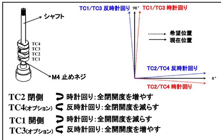
4. 電源を入れてアクチュエータを全開位置まで動かし、開側の機械的ストッパー(左側)を突き当たるまで締めて、その位置から1/2~1回転戻してください。
