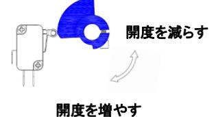
4. カム TC1 のボルトを仮固定して、電源を入れてアクチュエータを全開位置まで動かしてください。
