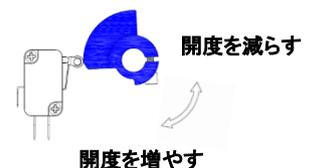
4. カム TC1 のボルトを仮固定して、電源を入れてアクチュエータを全開位置まで動かしてください。
