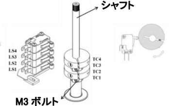
TC2 ゼロ位置検知: 電源障害時にスプリングがゼロ位置まで開放されていない場合、カム TC2 がリミットスイッチ LS2 を作動させていない状態のため、アクチュエータは再起動できません。
