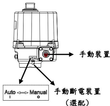
3. 操作完成後將手動斷電裝置從 "Manual" 模式切換至 "Auto" 模式。
