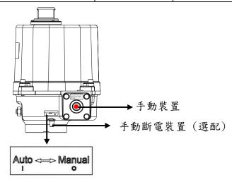
c. 操作完成後將手動斷電裝置從【Manual】模式切換至【Auto】模式。
