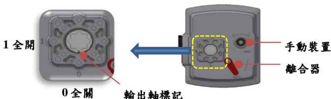
1. 裝入連軸器或固定座至驅動器之輸出軸，並鎖緊所有螺絲及螺帽。
